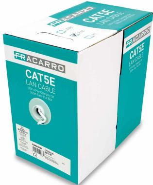
Cable de red interior CAT 5E con revestimiento de PVC, bobina de 305 metros compuesta por 4 pares balanceados de 100 ohmios con conductores de cobre rojo flexibles AWG 24. Las características cumplen con los requisitos de la **Cat. 5E Clase D** hasta 100 MHz, según las normas ANSI/TIA 568.2-D e ISO/IEC 11801. Apto para aplicaciones Gigabit Ethernet (IEEE 802.3ab).
